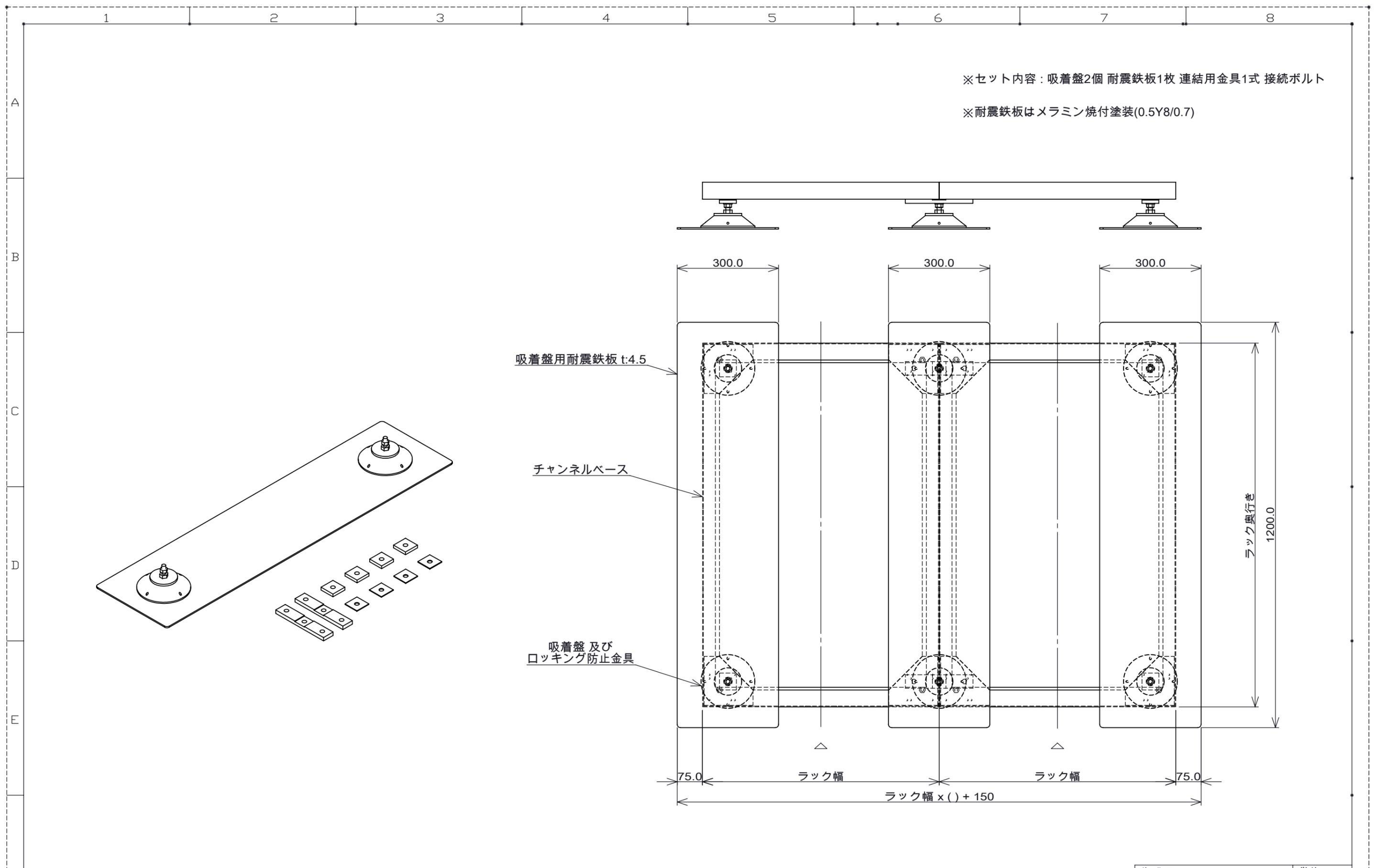
※セット内容：吸着盤2個 耐震鉄板1枚 連結用金具1式 接続ボルト
