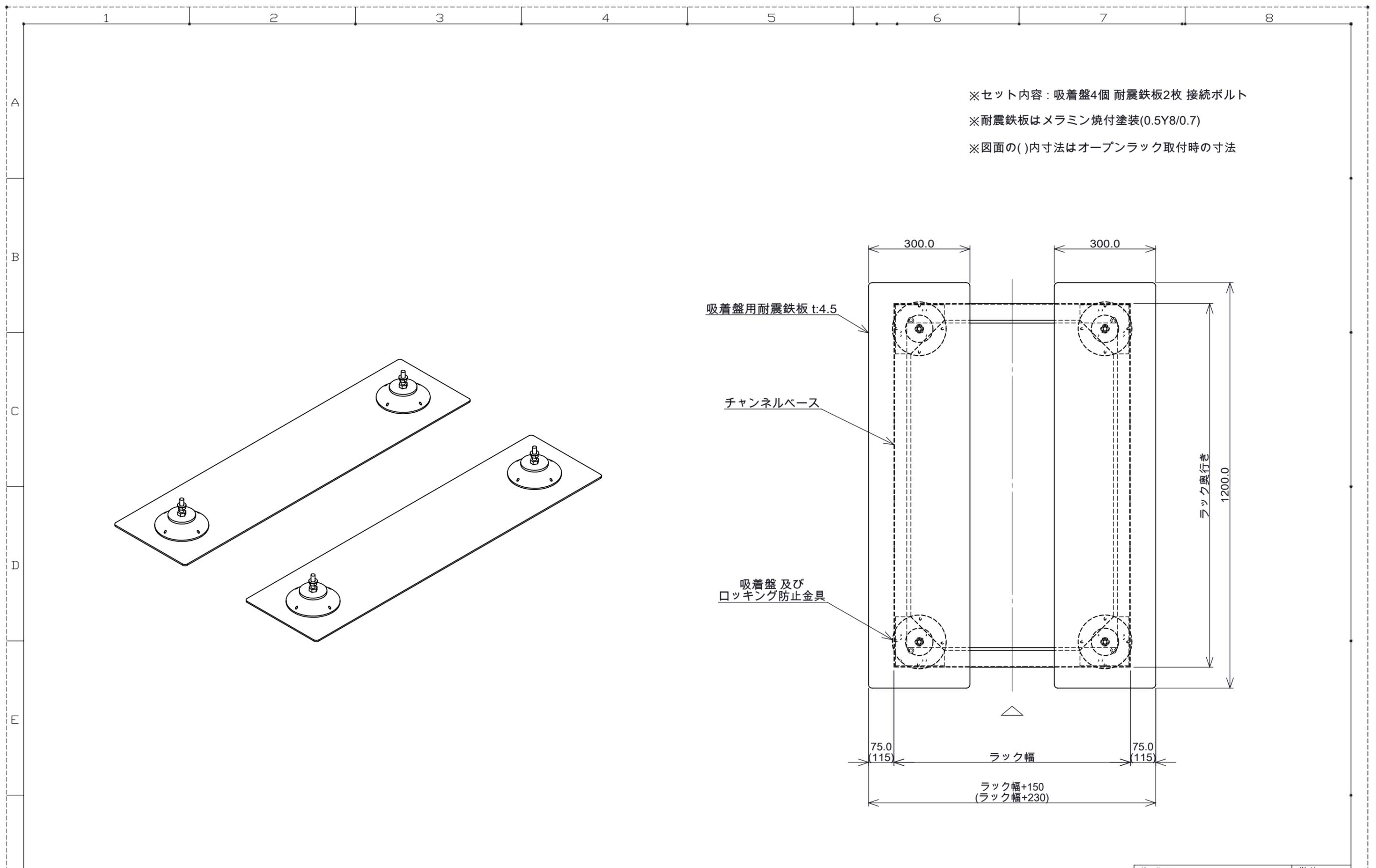
※セット内容：吸着盤4個 耐震鉄板2枚 接続ボルト
